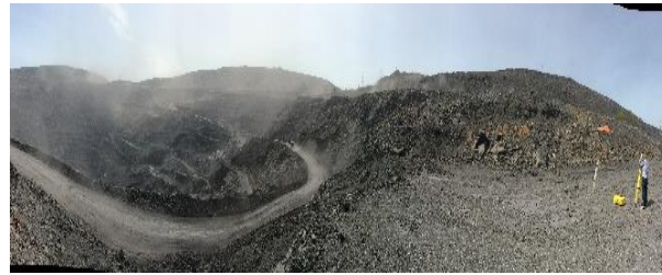
Hình 4. Thực nghiệm đo quét laser bằng máy GeoMax Zoom 300 tại khai trường mỏ Cọc Sáu trong điều kiện bụi và nắng.
